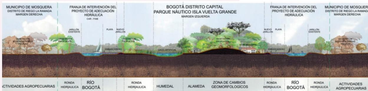
FCC Construcción ha desarrollado la ampliación de la sección hidráulica del río, así como la conformación de jarrillones de protección. Además, se ha realizado la excavación y dragado necesario para la ampliación de la sección hidráulica del río, obteniendo la sección tipo prevista. Todo ello posibilita que la amenaza de desbordamiento del río Bogotá, se minimiza con la reducción de los niveles de la lámina de agua como resultado de la ejecución de las obras
